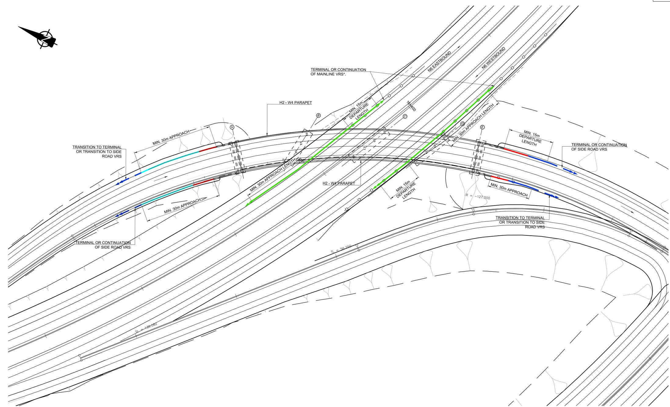
**PARAPET / SAFETY BARRIER LAYOUT**
